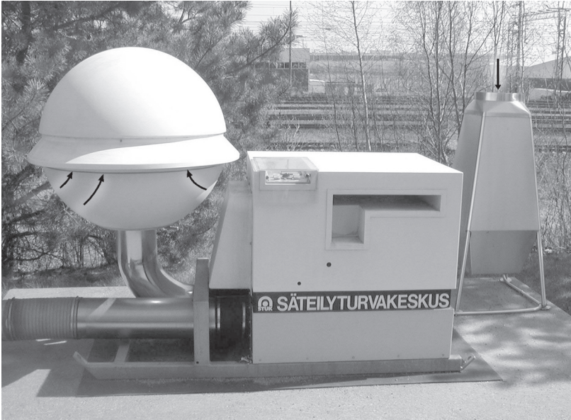
KUVA 3.15 Säteilyturvakeskuksen käyttämiä laitteita ilman (vasemmalla) ja laskeuman (oikealla) sisältämien radioaktiivisten aineiden keräämiseksi
