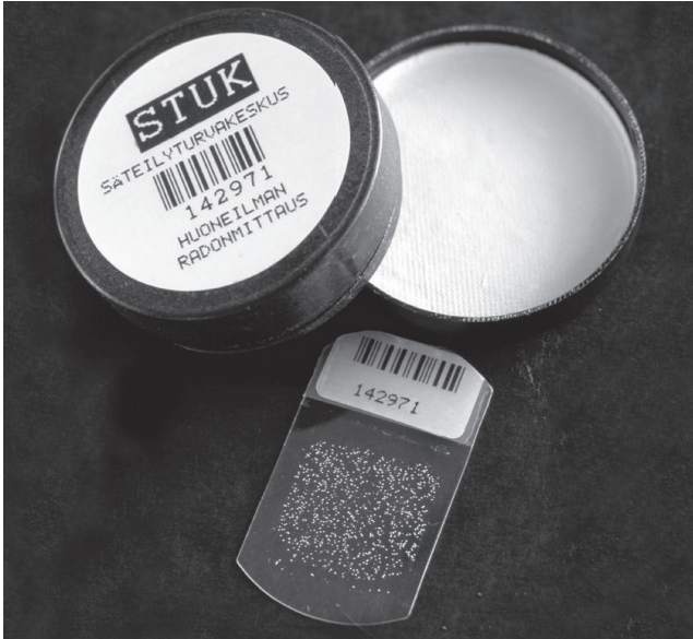
KUVA 4.14 Halkaisijaltaan viisisentimetrinen radonmittauspurkin sisällä on polykarbonaattikalvo.
