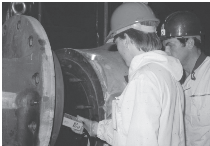
KUVA 4.3 Säteilyannosnopeuden mittaus ydinvoimalaitoksella
