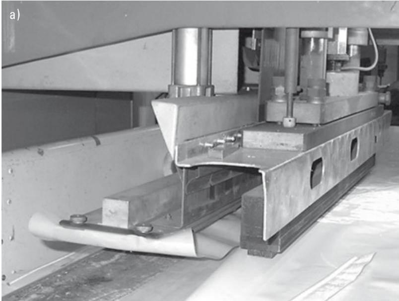
Kuva 9.16 Suurtaajuuskuumennin ja elektrodin rakenne (työterä)
