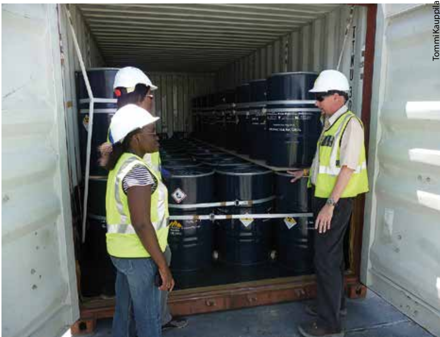
Langer Heinrichin kaivoksella uraanirikaste on standardin mukaisesti pakattu terästyneihin, jotka on lastattu merikuljetuskonttiin.
