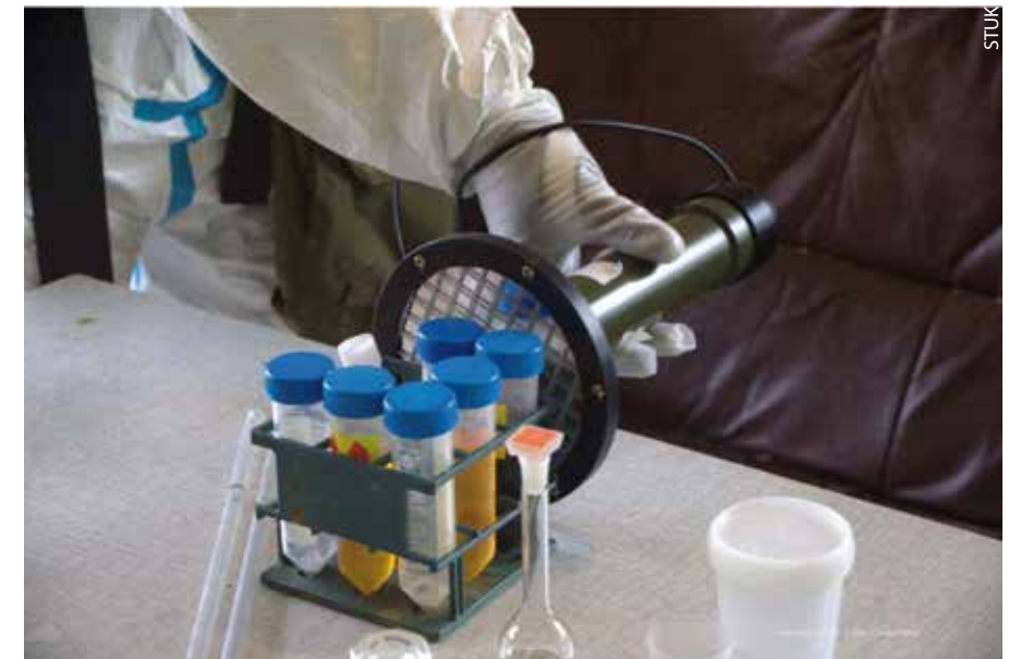
Alfasäteilyn havainnointia koeputkien pinnoilta. Säteilyturvakeskuksen mittausharjoituksessa. Laitteella ei voi havaita säteilyn energiaspekttriä.
