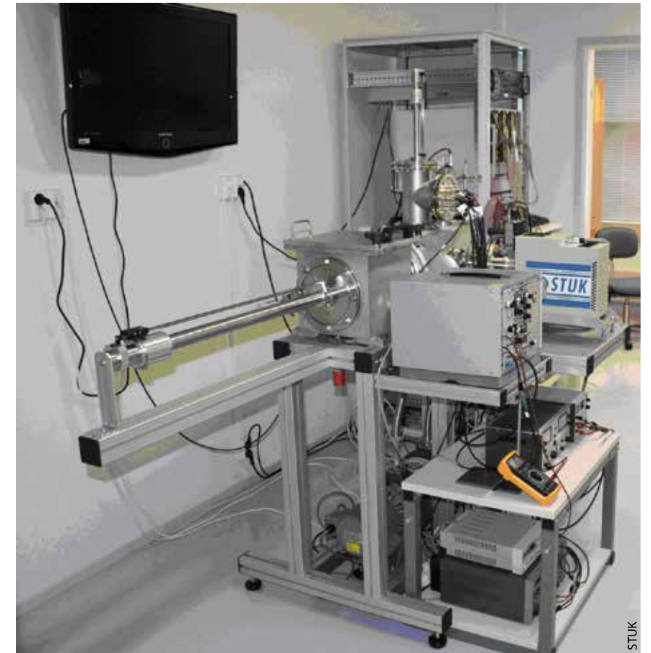
PANDA-mittauslaitteistolle näyte kelpaa sellaisenaan, eikä mittaus vaurioita näytettä.
