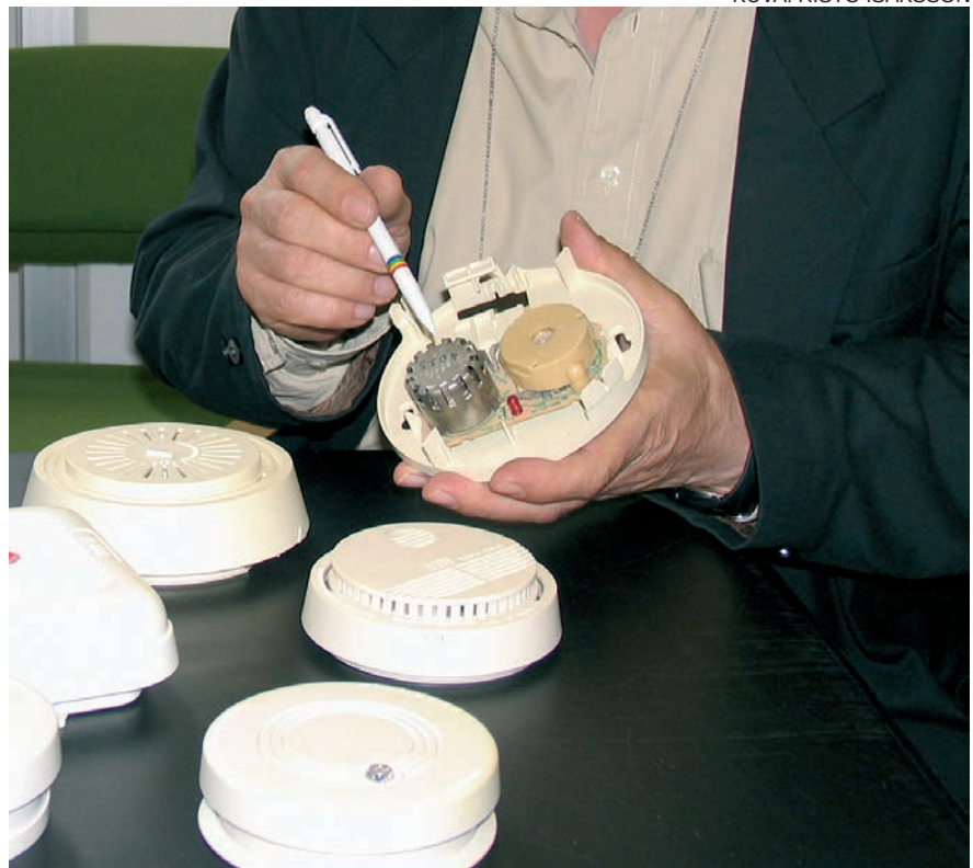
Palovaroittimen amerikkiumin on suljettu metalliseen ionisaatiokammioon. Kierrätykselle siinä on ongelma ratkaistavaksi: kuinka saada aine ulos mahdollisimman näppärästi.
