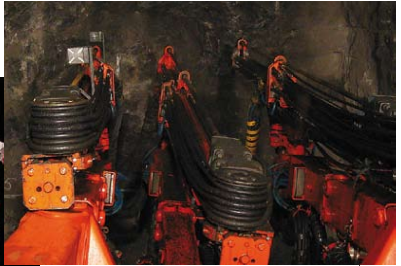
Onkalon louhinnan tärkein työkalu on lähes 17-metrinen ohjelmoitava porausjumbo.
