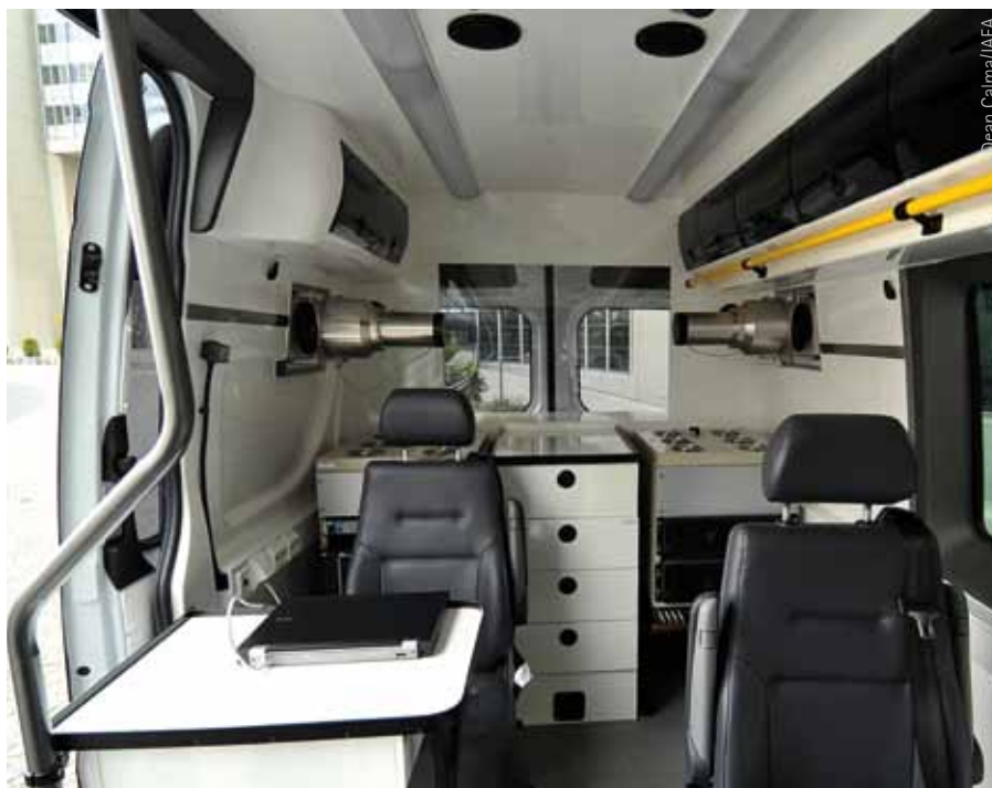
SONNIssa on useita spektrometrejä, joiden avulla radioaktiiviset aineet voidaan löytää ja tunnistaa. Tarkempaan analyysiin se osaa ottaa näytteitä ilmasta.
