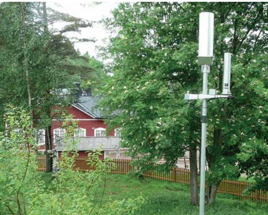
Ulkoisen säteilyn valvontaverkon anturi. Tolpan päässä oikealla puolella oleva putki on Geiger-Müller-anturi ja keskellä tolpan päässä näkyy LaBr 3 -ilmaisimen suojakotelossa.
