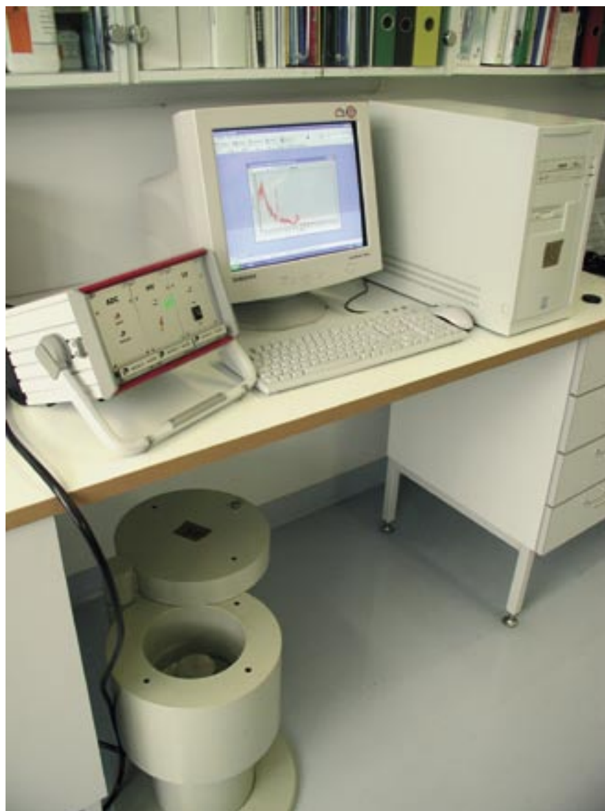
Uudenlainen gammaspektrometri on jo käytössä 23 paikallislaboratoriossa. Radioaktiivisia aineita, joiden pitoisuudet voidaan määrittää gammaspektrometrillä, ovat mm. kalium-40, cesium-134 ja -137, lyijy-210, radium-226 sekä uraani-235 ja -238.
